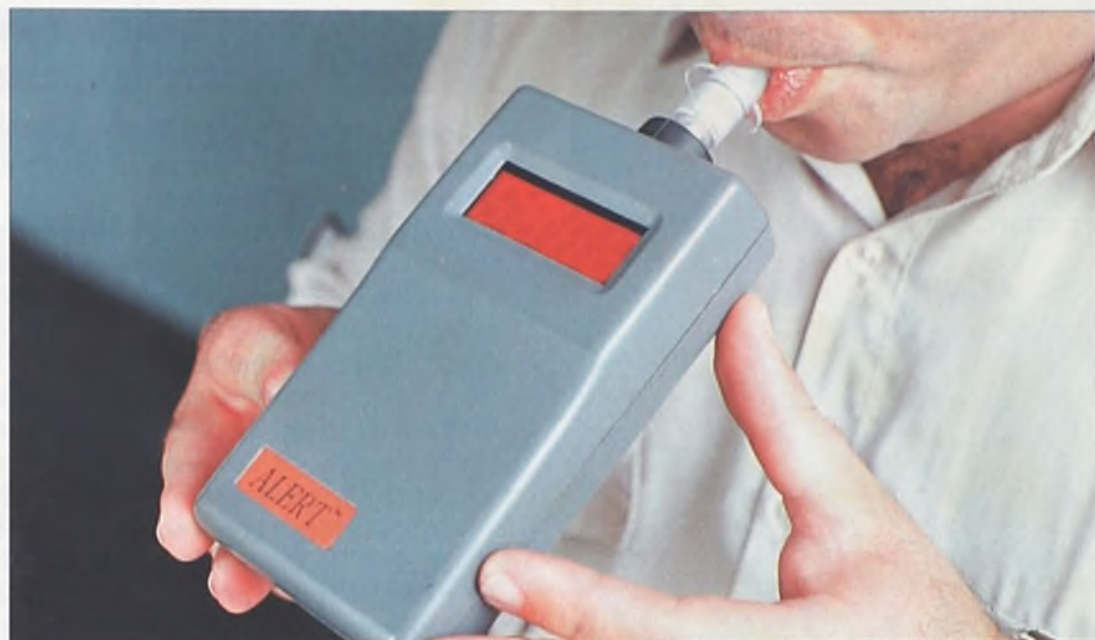
Espirómetro: dispositivo electrónico para medir la cantidad de alcohol en la sangre.
