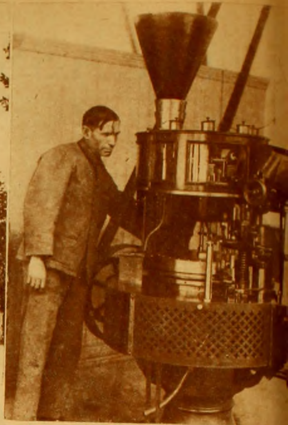
Taller de carga-munición que automáticamente deposita la cantidad precisa en cada cartucho
