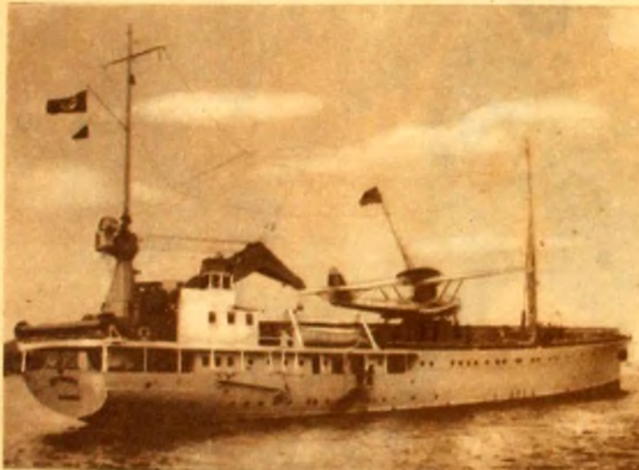
Un nuevo aerodromo flotante para el servicio aéreo entre Alemania y Sud América: "El Ostmark", especialmente construido para hidroaviones.
