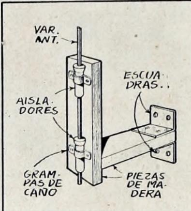
diagrama indica cómo se pasa la varilla de antena por los dos aisladores, los que a su vez se aseguran a una de las planchas de madera por medio de dos grampas para caño. La otra plancha de madera y las escuadras de hierro se emplean para mantener la antena alejada de la pared o de cualquier otro obstáculo.
