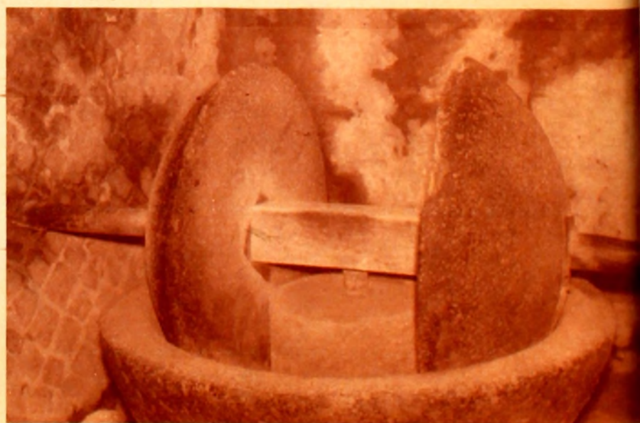
Molino de piedra que tanto se usaba para la molienda del trigo como de las aceitunas. Los dos discos verticales eran movidos a brazo dentro del gran receptáculo. Movimiento rotatorio horizontal en el plano del eje o barra que los une.
