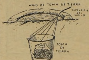
Disposición del recipiente medio llenado con coque
