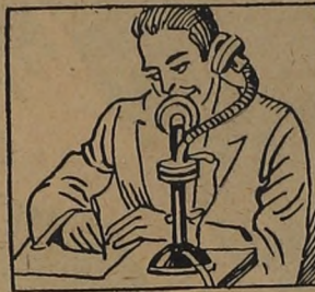
Brazo telefónico. — Su flexibilidad no impide poder mover la cabeza y es un progreso muy útil para poder conferenciar pudiendo leer o tomar notas con holgura.
