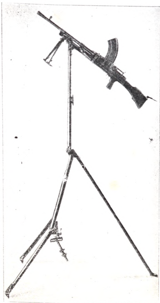
El mismo trípode se adapta para colocar el fusil ametralladora BREN en posición de tiro antiaéreo
