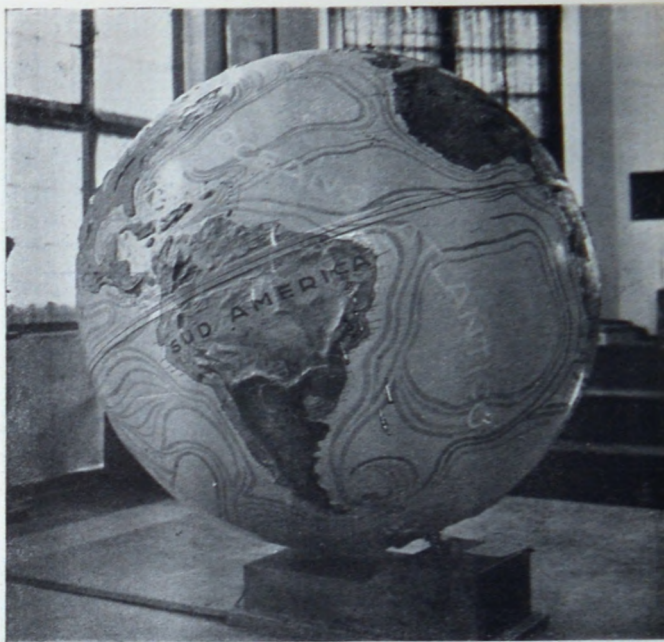
Museo de Técnica y Ciencia. — Gran globo terrestre con movimiento rotativo electro-mecánico, construido en los talleres de la Escuela.
